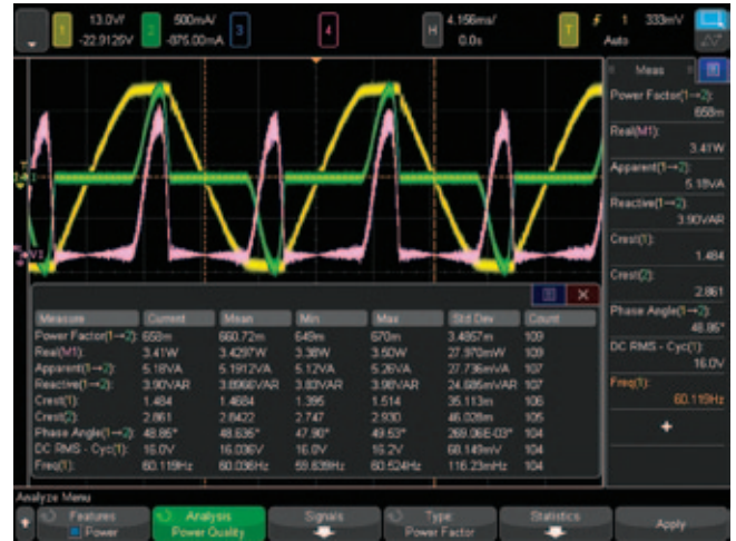
图 25: 电力质量测量, 一种功率测量应用软件。
