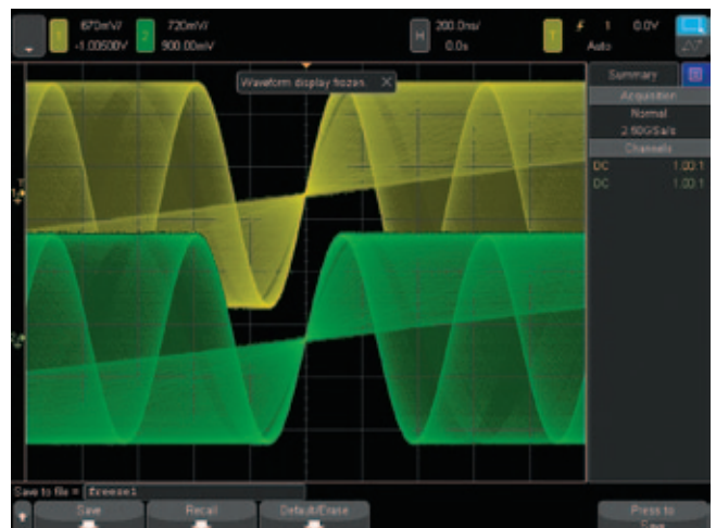
图 43: “冻结显示”特性可在停止波形采集的同时在屏幕上保留亮度级信息。
