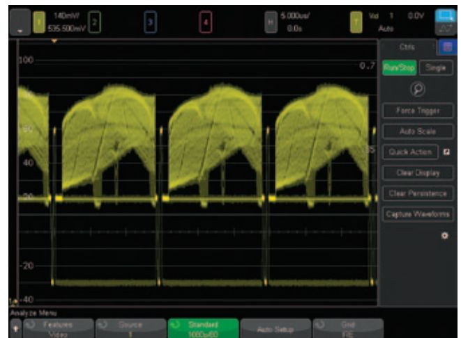
图 26: 在 1080p HDTV 信号分析上进行触发。
