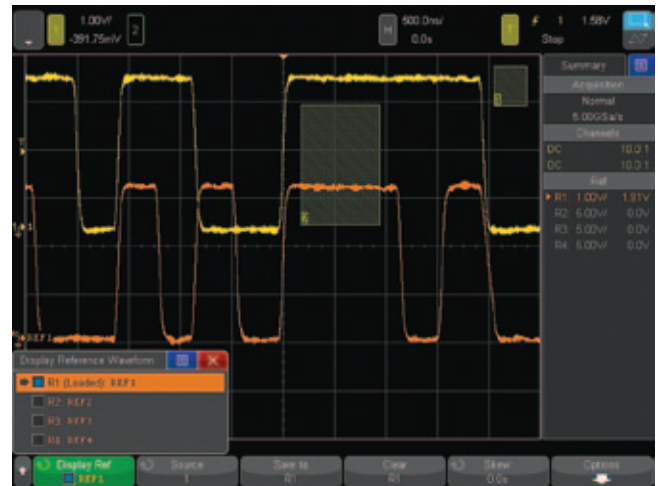
图 33: 存储和调用多达 4 个参考波形。
