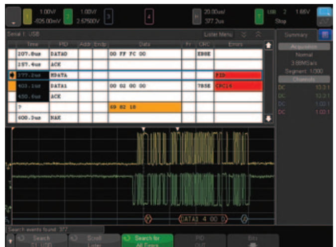
图 20: USB 2.0 触发、解码和“列表”显示。
