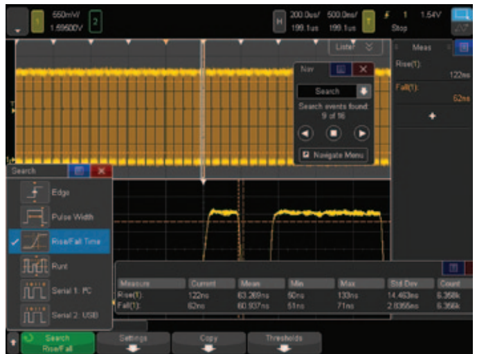
图10: 4000 X 系列能够使用不同的上升沿捕获数据信号。使用搜索和导航功能, 示波器能够查找、标记(白色三角形)和快速导航到16个出现“不符合一致性的”上升沿的位置。
