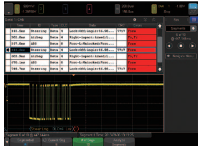
图8: 分段存储器与串行解码配合使用,能够对串行总线进行最深入的分析。
