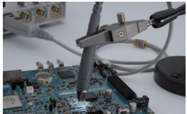
图 34: 只需一个探针，并且无需更改或重新连接，N2750A InfiniiMode 探头可灵活支持差分、单端和共模信号测量。
