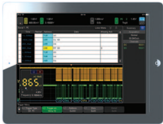
图 37: 平板电脑虚拟前面板控制界面。
